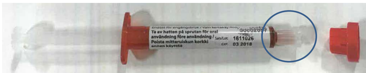
Figure 2 : lors du retrait du capuchon rouge, le capuchon blanc de l'embout reste sur la seringue (retrait anormal, comme rapporté, photo d'une présentation étrangère)
