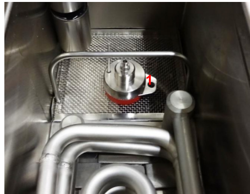
Abb. 4 Sensorplatzierung im Kammersumpf.
