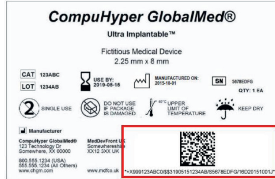
Abbildung 14: Beispielhafte Darstellung einer Etikette mit UDI in maschinenlesbarer und menschenlesbarer Form (rot umrahmt) auf einer fiktiven Etikette 114
