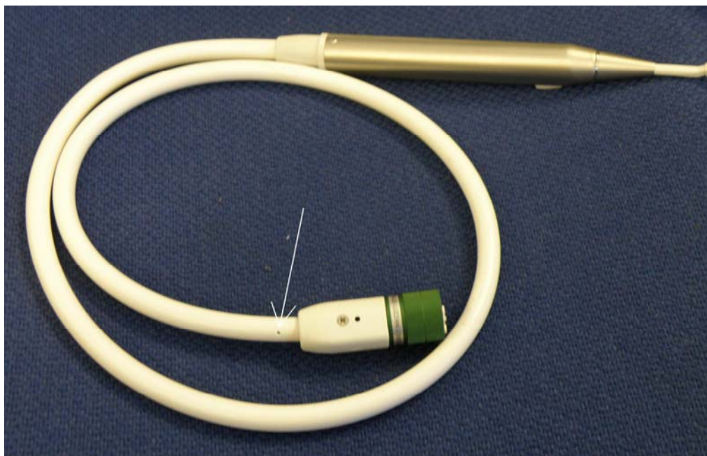
Figura 1. Cordone dello strumento con foro
