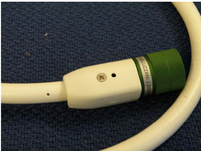
Figura 3. È importante praticare un foro perfettamente rotondo per evitare la lacerazione del cordone
