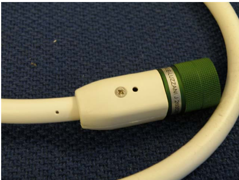
Figure 3. Il est important que le trou soit rond pour éviter que le cordon ne génère des éclaboussures
