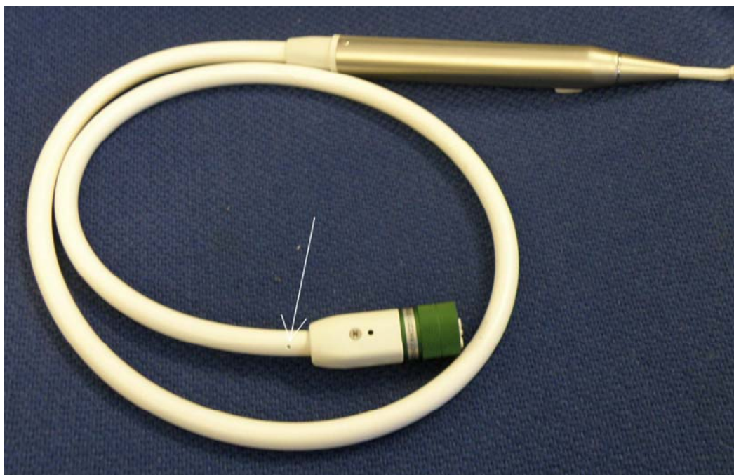
Bild 1. Instrumentschlauch mit Loch
