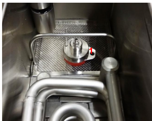
Illustration 4 Placement des capteurs dans le puisard de la cuve.
