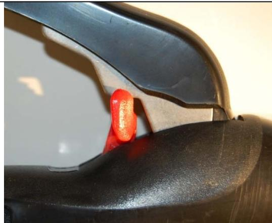
Fälschung: Keine Chargennummer am Auslösehebel
